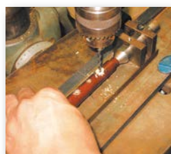
10 指孔を空ける ボール盤で指孔を空けます。
