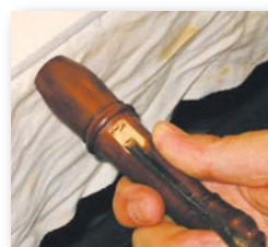
6 鳴りを調整する ウィンドウェイ、ブロック、エッジを削って 鳴りを調整します。
