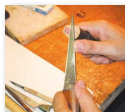
8 吹き口を形成する 糸鋸、ナイフで吹き口の形を作ります。
