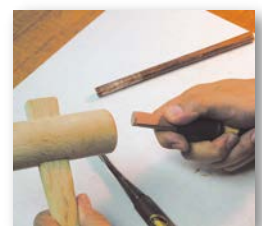
7 ブロックを入れる ブロックを少しずつ削りながら入れて いきます。
