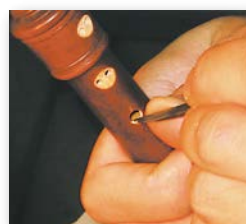
11 最終調整 ひとつひとつ鳴らしてみても体感的に調整を行います。
