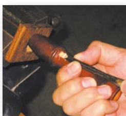
4 窓を開ける ノミで窓を開けます。
