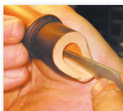
9 鳴りを仕上げる ブロックやウインドウエイを削って鳴りを仕上げていきます。
