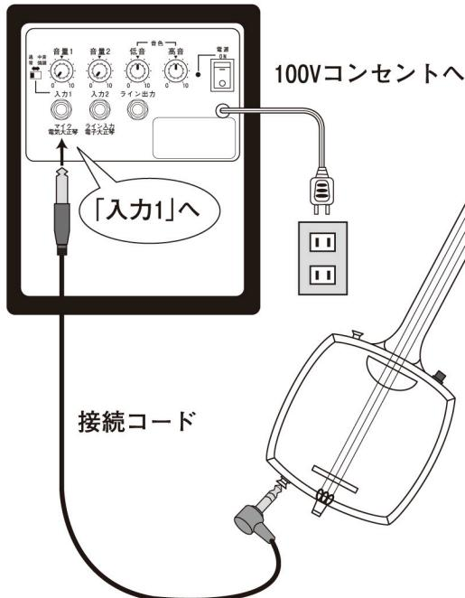
1. アンプの音量を最小にし、本機のエンドピンジャックとアンプの入力ジャックを、接続コードで接続します。
