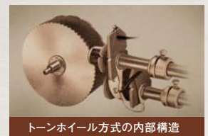
トーンホイール方式の内部構造
