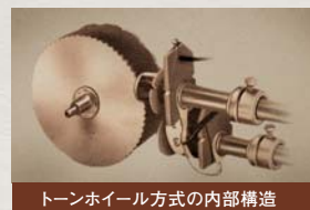
トーンホイール方式の内部構造
