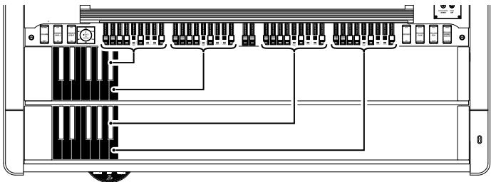
各ドローバーの中で、白の左端(8')のドローバーが基音(基準になる音程)を作ります。その他の白いドローバーは右へ行くほどオクターブずつ高くなります。
