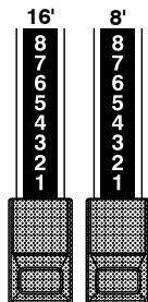
PEDALパートは主にベースラインを演奏するためのもので、ハーモニクスの調節には16'及び8'の2本のドローバーを使用します。16'で重低音を作りだし、8'はその上のオクターブの音を出します。ペダルパートのレジストレーションはディスプレイ中央に表示されます。左側が16'、右側が8'です。
