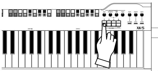
ここで言う「パーカッション」とは打楽器のことではなく、音に歯切れ良さを加えるための減衰音のことです。必要に応じてドローバーの音にミックスして使用します。なお、パーカッションはUPPERパートでのみ発音します。
