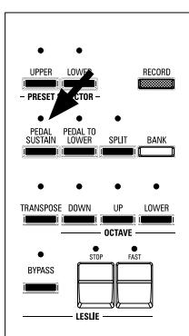
PEDALパートの音が離鍵時にすぐ消えてしまうのではなく、滑らかに消えていくようにできます。これを「ペダルサステイン」と呼びます。
