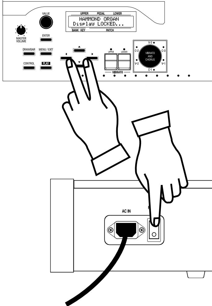
ディスプレイ操作をロックするには、[POWER]スイッチを入れる際に[◀]と[▶]ボタンを“Display LOCKED”が表示されるまで押し続けます。
