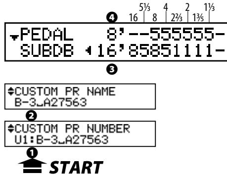
サブドローバーは、手鍵盤パートのオルガンタイプがA-100、B-3、C-3またはMellowで、且つPEDALパートのオルガンタイプが“Normal”の時にのみ有効な機能です。この画面に入ると、それが自動的に選択されます。
