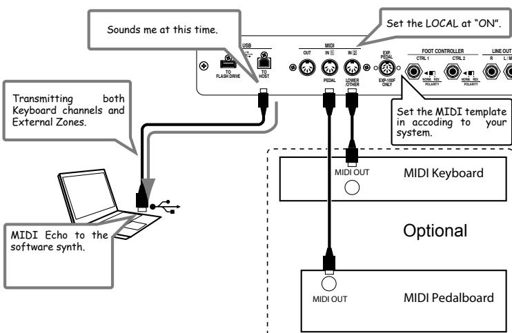
エクストラナルゾーンで発音させたいMIDI音源がコンピューター内のソフトウェアシンセサイザーの場合、本機のローカルコントロールを“ON”に設定します。
