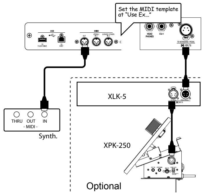
ローラー鍵盤とペダル鍵盤にMIDIキーボードではなくXLK-5とXPK-250を使用している場合は、図のように接続します。
