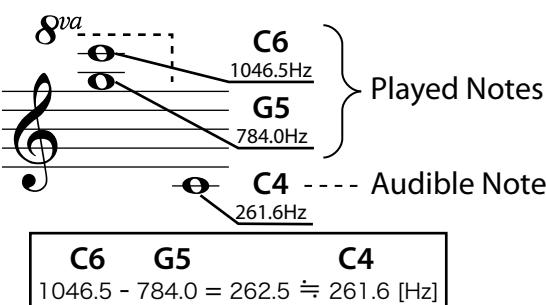
非直線歪みの特徴として、「差音」の強調があります。例えば、ドローバー8'のみを引き出して“G”とその上の“C”を弾くと、2オクターブ下の“C”が聞こえます。これが差音です。
