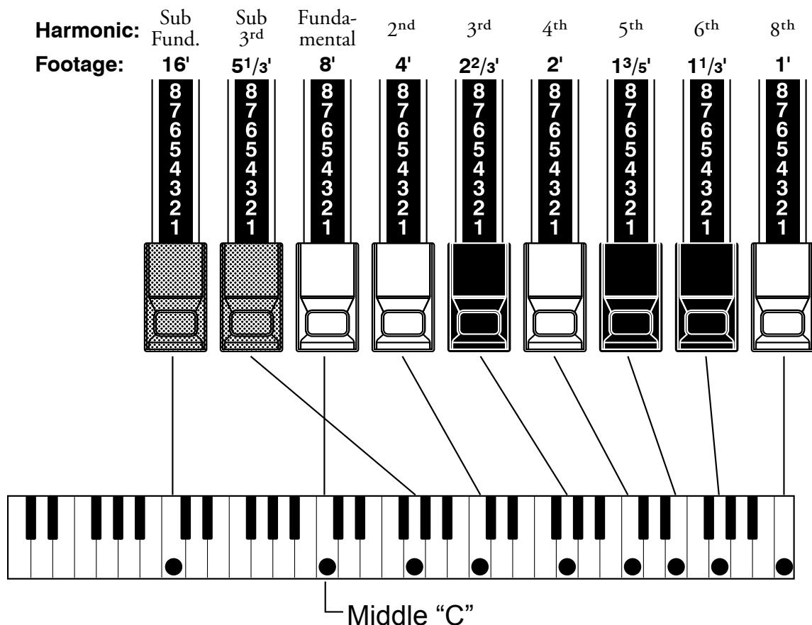
中央のC(ド)を押さえたとき、各ドローバーの音程は上図のようになります。また、ドローバーに記されているフィート(')という表示は、元々パイプオルガンのパイプの長さから転用された言葉です。
