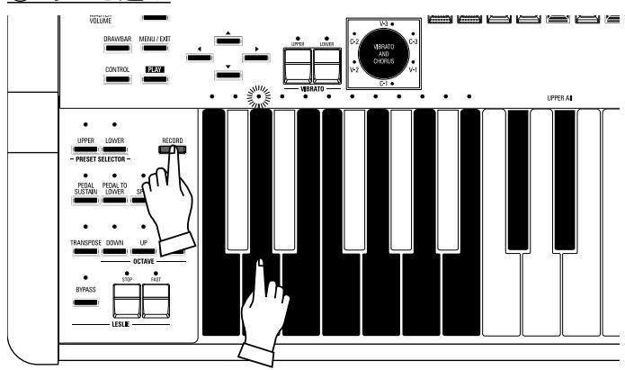
[RECORD]ボタンを押しながら、プリセットキー[D]を押します。プリセットが確定し、ディスプレイに“Recording Patch”が表示されます。記憶処理が完了すると、ディスプレイは元の画面に戻ります。
