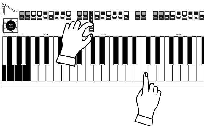
低音側から2グループめの、<sup>アバ</sup><sub>バ</sub> “B”ドローバーを好みの状態に引き出します。鍵盤を弾きながら行うと確認が容易です。
