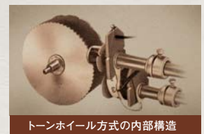
トーンホイール方式の内部構造
