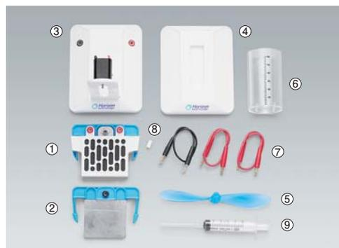
FCJJ-34はマグネシウムと空気中の酸素を使用して発電する燃料電池学習キットです。電解液として食塩水を使用し、その濃度や温度を変化させることで発生するエネルギーが変動することを学習できます。
