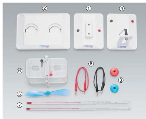
FCJJ-38はペルティエモジュールと呼ばれる電子部品を使用し、モジュールが挟まれた2つのタンクに異なる温度の水を入れ、その温度差によって発電を行う実験キットです。ペルティエモジュールとは、2つの金属の接合部に電流を流すと金属から金属へ熱が移動するペルティエ効果を利用した電子部品で、直流電流を流すとモジュールの片面が発熱し、反対面が吸熱されます。その際の電流の極性を逆転させることで、温度差から電圧を発生させることができ、その効果を利用して発電を行います。
