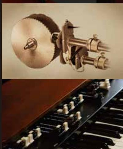
ハモンドオルガン独特の暖かく揺らぎのある音は「トーンホイール」と呼ばれる発音原理によるもの。トーンホイールは金属の歯車で、回転すると磁界の揺れが発生し、電磁誘導によるコイルに正弦波が生じます。これを増幅したものがハモンドの音色でした。個体差、製造年代からノイズに至るまで、すべてが奇跡的な音色の味付けともなるハモンドオルガンのサウンドは、現在デジタル・トーンホイールとして唯のサンプリングに留まらない、常に最新の技術でそれらの再現に挑戦しています。
