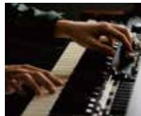
現在でも人気の高いヴィンテージオルガンB-3の鍵盤は多列接点と呼ばれる方式を採用していました。この鍵盤は、押し下げる具合で異なる倍音（ドローバー）がバラバラに発音して行くため、少しだけ押し下げた分の音だけを出すといったアコースティック楽器の様に操る技術や楽しさ、表現力がありました。現在も、この仕様によって生まれる様々な要因がジャズやロックをはじめとするポピュラー音楽においてハモンドオルガンを特徴づける音色や奏法の重要なファクターとなっています。XK-5は、この特徴を仮想マルチ・コンタクト鍵盤（Virtual Multi-Contact Keyboard）と、新音源MTW I音源といった、メカニカル・デジタルの両技術で再現。本物のオルガンを演奏する喜びと楽しさを気軽に手にして頂けるようになりました。
