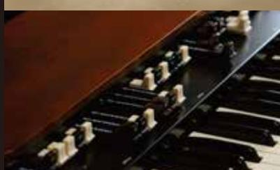
ハモンドオルガンの代表的な特徴ともいえるハーモニック・ドローバー。16'(16フィート)など、パイプオルガンのパイプの長さが印されたこのドローバーを引き出し、倍音を重ねることで音色を変化させます。倍音豊かなトランペットやバイオリンは華やかな音色、対してフルートなどのあまり含まない楽器はさらっと聞こえる様に、その自然の音に含まれる倍音を電気的に操作可能にしたのがドローバーでした。このドローバーを自分で引き出し音を創り出すというアナログ的な方法は、ハモンドが電子楽器でありながら、アコースティック楽器を操るような不思議な魅力も併せ持っています。
