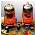
プリアンプ回路には2本の真空管、12AU7と12AX7が搭載されています。オリジナルB-3にも搭載されていた12AU7はオーバー・ドライブを担当、かつてエクスプレッション・ペダルのトリマーを調整することによって得られていたまるやかなクリップを、つまみ一つで得ることができます。12AX7はバッファーとして、サウンドに暖かみを与えます。バイアス・コントロールを調整することでオリジナルB-3でありがちな真空管のはらつきや、経年変化などで発生する歪みも再現できるようになりました。
