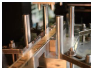
スズキハーモニカは少ない息でもよく鳴ります。それは全て精度の高さによるもの。例えばプレートは薄い板状の部品ですが、材料から加工する際には大きなプレス機を用いて、200tという非常に強い力をかけて一気に抜きます。そのため加工されたプレートは高い精度を持った美しい仕上がりになります。一方、リードは8/100ミリという極小単位での微調整を行いながら加工していきます。ひとつひとつ高い精度で加工されたパーツの集合体、それがスズキハーモニカなのです。
