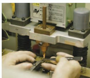
リードは、とても小さく薄い繊細な部品です。音の要であるこの部品に音程の狂いは許されません。スズキではハーモニカが1本出来上がるまでに4回もの音のチェックが行われています。1回目はリードを型で打ち抜く時、2回目はリードをプレートに取り付けた後、3回目はリードプレートをボディに取り付けた後、そして4回目はカバーを取り付けた後に、それぞれ1音1音、チェックを行っています。また同時に、空気漏れや傷などの品質のチェックも怠りません。厳しいチェックに合格したものだけがスズキハーモニカとして皆様のお手元に届きます。
