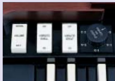
■写真7 内蔵のコーラス・エフェクト設定スイッチ。ボリュームをNORMAL、ピブラートスウェル(上鍵盤用ピブラート)をON、ピブラートグレート(下鍵盤用ピブラート)もONし、コーラスの種類はChorus 3(C3)に設定している。
