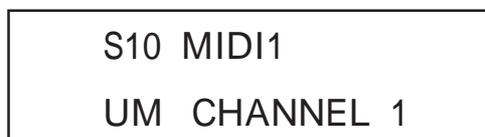
もう1度SYSTEMスイッチを押すとユーティリティモードになります。SYSTEMスイッチを押す度にエディット#のジャンプを繰り返します。
