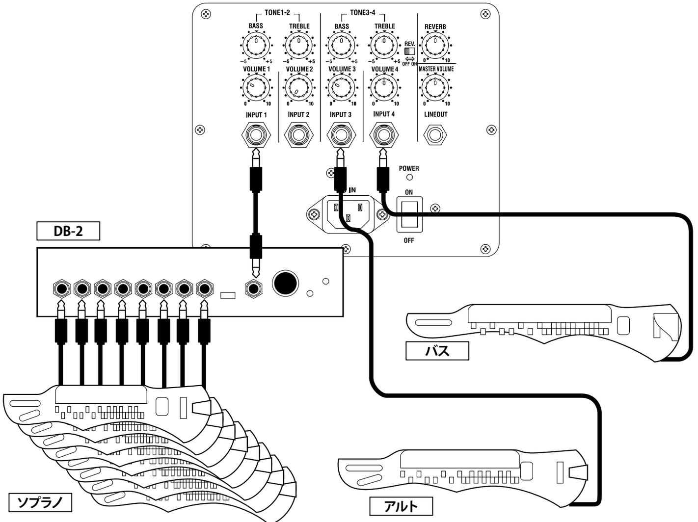
本機に同一機種の電気大正琴を多数接続したい場合は、大正琴ダイレクトボックス DB-2 を使用します。
