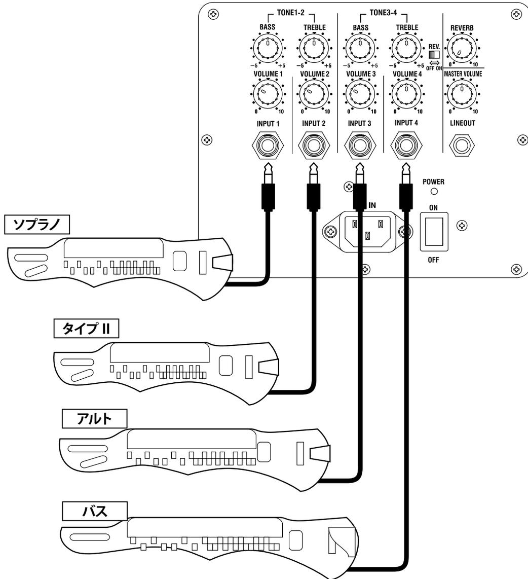
本機は4チャンネルの入力を備えていますので、4台までの楽器を直接接続することができます。各INPUTジャックとも全ての電気大正琴に対応しておりますので、大正琴を接続後、各楽器とも適切な音量バランスになるよう各[VOLUME]つまみを調節します。その後、全体の音量を[MASTER VOLUME]つまみで設定します。小会議室程度であれば、本機1台で十分な音量を得られます。
