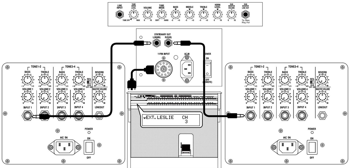
A-405 や XK-3C など 3 チャンネル仕様のレスリーコネクタを持つ Hammond オルガンとレスリー 3300 や 2101 のように “STATIONARY OUT” ジャックを持つレスリースピーカーをお持ちの場合、本機をストレートなドロワー音やオーケストラ音を再生するための「ステーションナリーユニット」として使用することができます。
