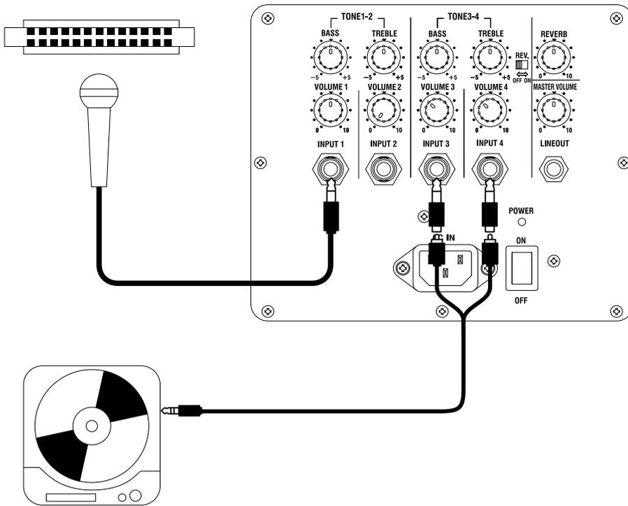
ハーモニカ用マイクは <sup>インプット</sup> INPUT 1 に接続し、伴奏用として CD プレイヤーなどを使用する場合には INPUT 3 と 4 に接続します。これにより、ハーモニカと伴奏とで音質調整が別々に行えます。
