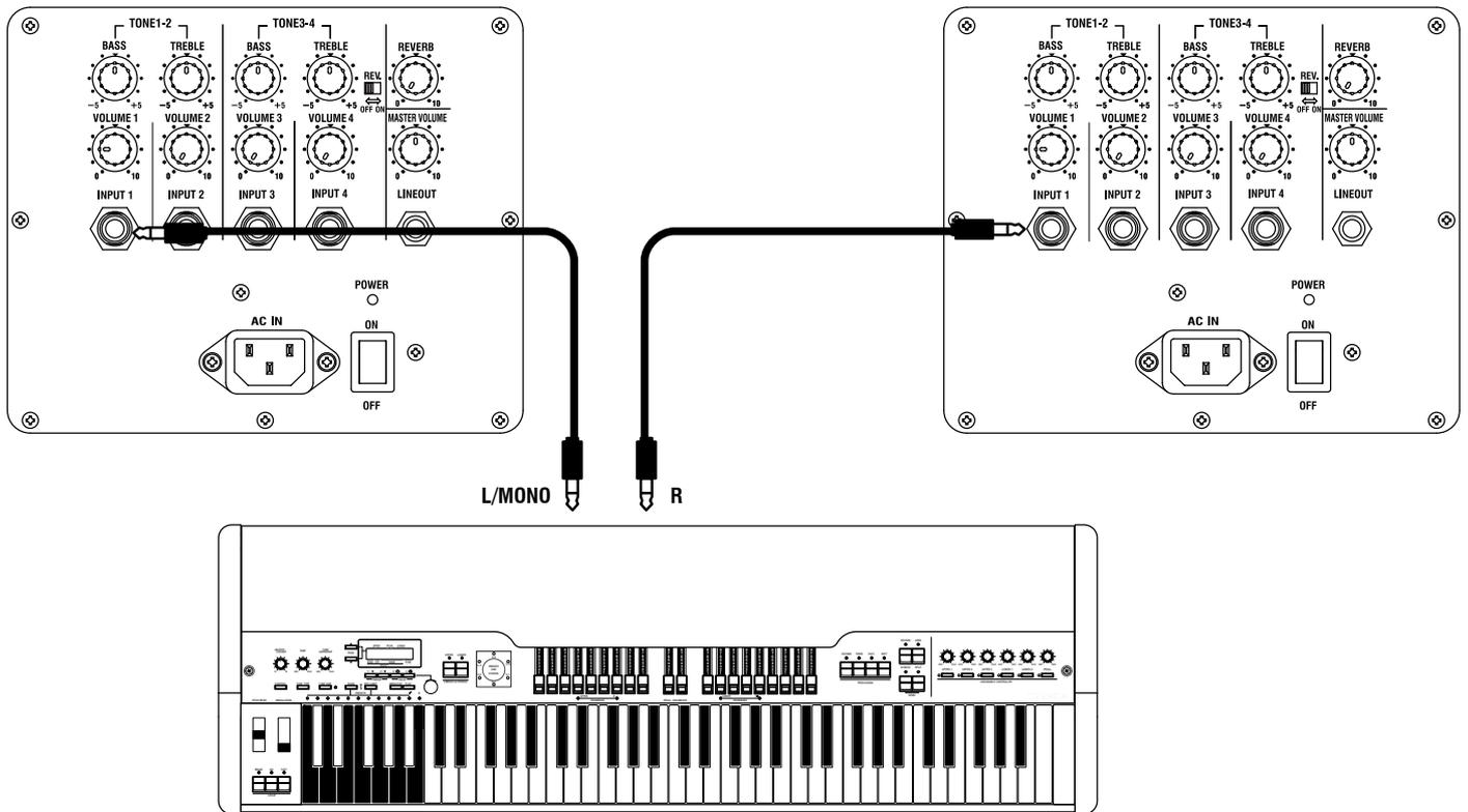
ライン出力を持ったオルガンやシンセサイザー、キーボードは比較的出力レベルが大きいため、本機の [VOLUME] つまみを中央より左に設定すると良い結果が得られます。スピーカーの音量は [MASTER VOLUME] つまみで調節します。
