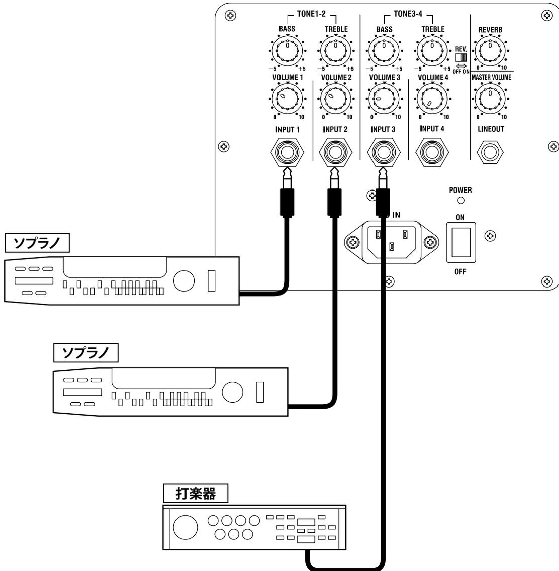
上図は2台の電気大正琴と電子打楽器 DPS-100「拍調」を使った邦楽アンサンブルでの接続例です。
