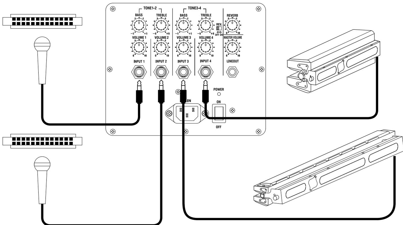
上図はメロディ用ハーモニカ 2 台、コードハーモニカ、そしてバスハーモニカによるハーモニカカルテットの接続例です。メロディ用マイクは [INPUT 1] と [INPUT 2] へ、コードハーモニカ用マイクは [INPUT 3]、バスハーモニカは [INPUT 4] へ接続します。
