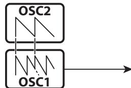
二つのオシレーターがあり、OSC1は演奏に対して「ずれた」音程で発音しようとしていますが、本来の音程で発音するOSC2に強制的に同期させられるため、強烈な倍音が発生します。
