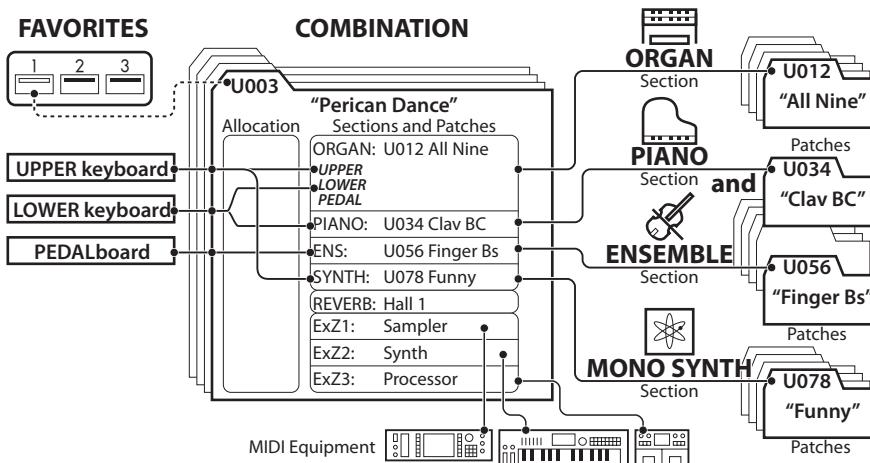
各鍵盤の演奏は「コンビ」で設定された各「セクション」に「アロケート」され、「パッチ」で設定された音色で発音します。
