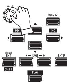
ピアノ／アンサンブル・セクションのベロシティ(鍵盤を弾く強さ)に対する感度を調節するには、プレイ画面、ピアノ／アンサンブル・セクションのVELにカーソルを移動し、[VALUE]つまみで調整します。
