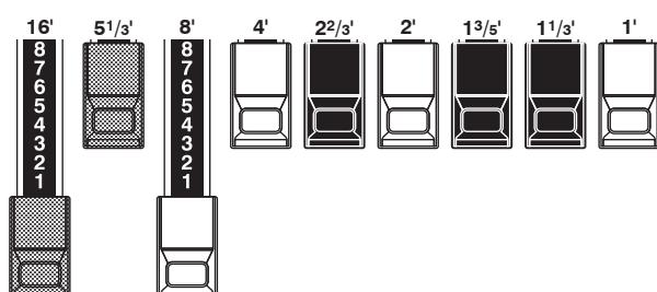
PEDALパートは主にベースラインを演奏するためのもので、倍音の調節には16'及び8'の2本のドローバーを使用します。
