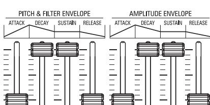
エンベロープ・ジェネレーターとは、音を時間的に変化させるための仕組みです。
