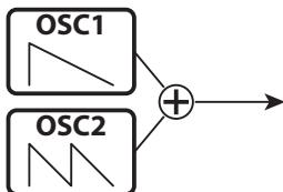
二つの周波数の異なるオシレーターが発音します。OSC1は本来の音程で、OSC2は演奏に対して最大1オクターブの「ずれた」音程で発音します。OSC2の音量を0にすると、完全な単音が得られます。ベースやリード、擬似的な和音まで、最も多用途に使えるオシレーター・タイプです。
