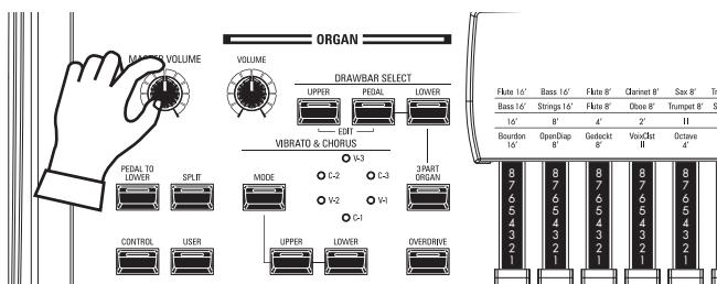
オルガン・セクションの音量を調節するには、同セクションの[VOLUME]を操作します。
