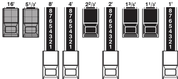
各ドローバーの中で、白の左端(8')のドローバーが基音(基準になる音程)を作ります。その他の白いドローバーは右へ行くほどオクターブずつ高くなる、偶数倍音です。
