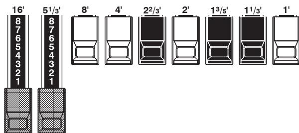
左端の2本の茶色いドローバーは、音色に深みと豊かさを加える役目をします。左の16'は8'の1オクターブ下の音、5 1/3'は16'を基音とする第3倍音です。
