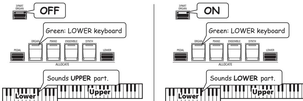
**On** ..... オルガン・セクションは3段鍵盤のオルガンとして動作します。例えばオルガン・セクションをロワー鍵盤にアロケートするとLOWERパートが発音します。
