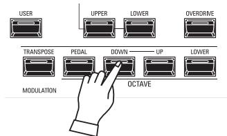
他のセクションを含めた UPPER 鍵盤全体のオクターブを移動するには、OCTAVE [DOWN] または [UP] ボタンを押します。ディスプレイにはオクターブ値が表示されます。
