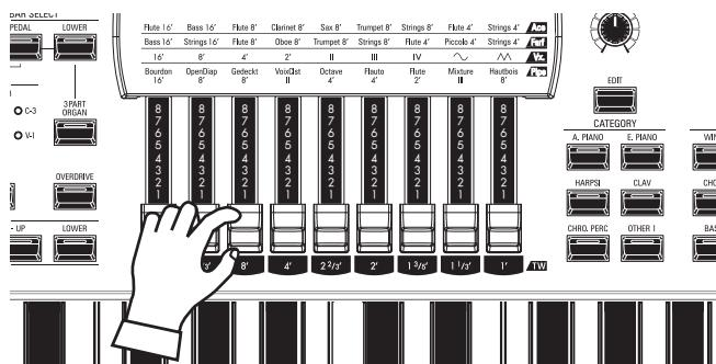
ドローバーはオルガンの基本的な音色を作るためのつまみです。鍵盤を弾きながらドローバーを操作すると、確認が容易です。
