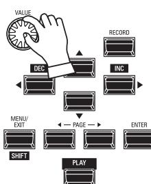
ピアノ・セクションのみのオクターブを移動するには、プレイ画面、ピアノ・セクションのOCTにカーソルを移動し、[VALUE]つまみで調整します。
