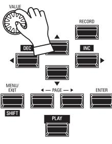
モノシンセ・セクションのみのオクターブを移動するには、プレイ画面、モノシンセ・セクションの OCTAVE にカーソルを移動し、[VALUE] つまみで調整します。
