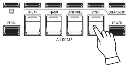
モノシンセ・セクションを本体の鍵盤(UPPER)に割り当てるために、アロケートボタン群の[SYNTH]ボタンを押してランプを点灯させます。
