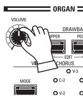
オルガン・セクションの音量を調節するには、同セクションの [VOLUME] を操作します。
