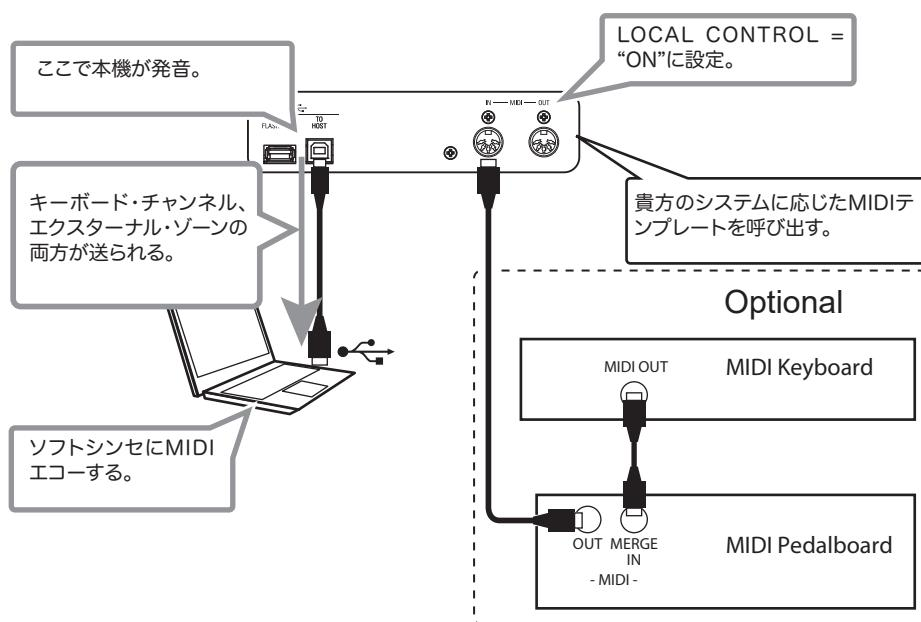
エクストナルゾーンで発音させたいMIDI音源がコンピューター内のソフトウェアシンセサイザーの場合、本機のローカルコントロールを“ON”に設定します。
