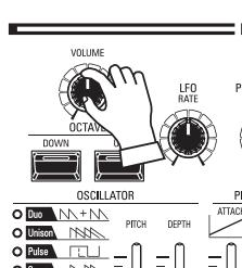
モノシンセ・セクションの音量を調節するには、同セクションの [VOLUME] を操作します。
