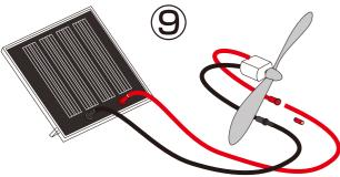
**9** 図のようにケーブルを使用してファンを取り付けたモーターにソーラーパネルをつないでください。十分な太陽光がある場合、
