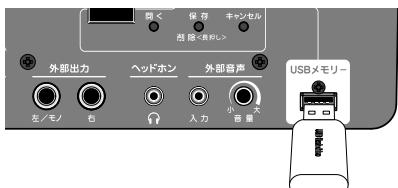
USBメモリーが本機に正しく接続され、ディスプレイに“00”等の数字が表示されていることを確認します。
