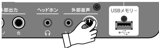
オーディオプレイヤーを再生しながら、本機の[外部音声音量]つまみをゆっくりと時計回りに回し、適当な音量に設定します。
