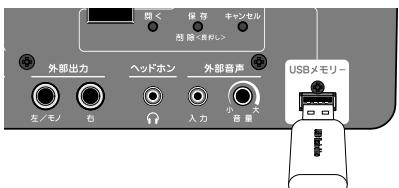
USBメモリーを本機に正しく接続し、ディスプレイに“00”等の数字が表示されていることを確認します。
