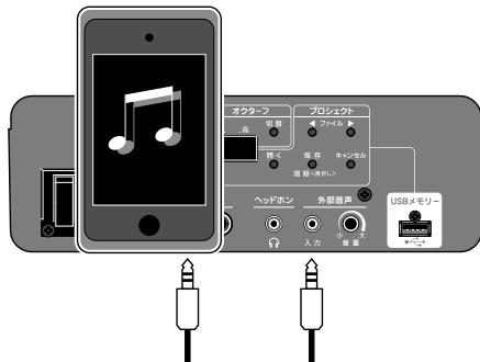
オーディオプレイヤーの出力ジャックと本機の[外部音声入力]ジャックとを、ステレオミニプラグの接続コード（別売）を使って接続します。
