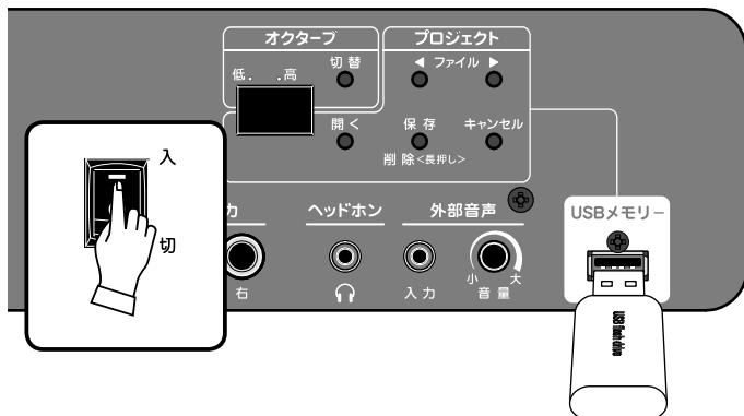
本機の電源を入れ、WAVファイルがコピーされたUSBメモリーを本機に接続します。
