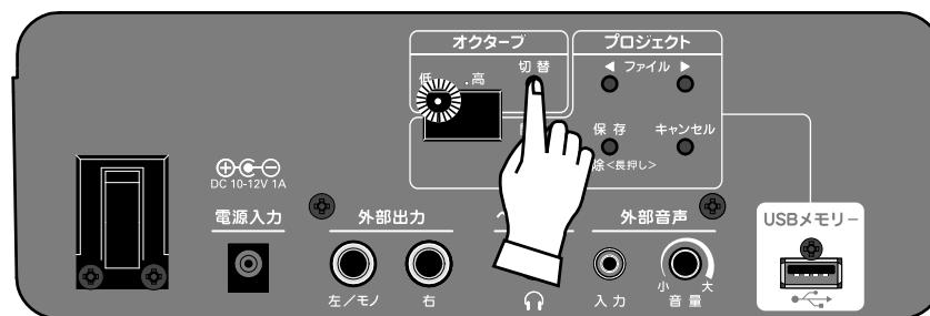
[オクターブ切替]ボタンを押す度に、高い→低い→標準の順でオクターブが移動します。
