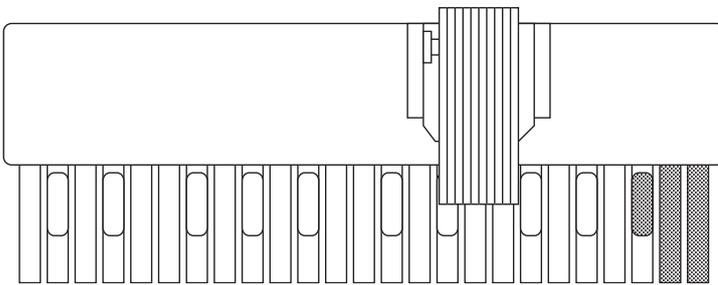
本機の設定を工場出荷時と同じ状態に戻すには、最も高い「シ♭」、「シ」、「ド」のキーを踏みながら電源を入れます（左図参照）。
