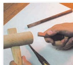
6 ブロックを入れる ブロックを少しずつ削りながら入れていきます。
