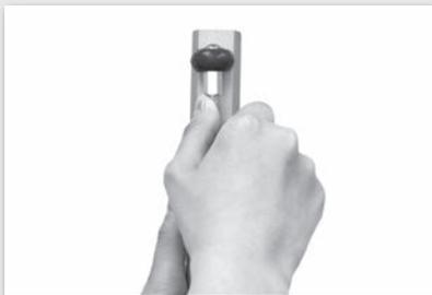
アームを手で右、又は左に曲げて、本体中心線上にヘッドが接触するようにする。
