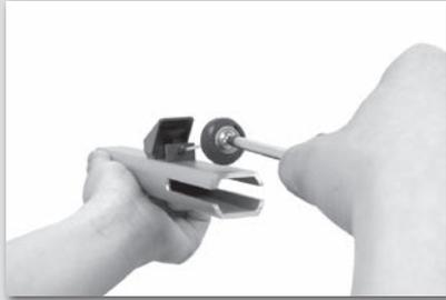
市販のドライバー(No.2)でヘッドの取付けネジを締める。
